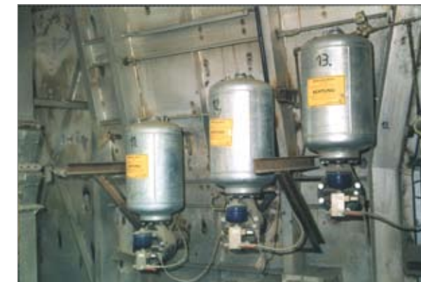
Воздушные джины типа „Shockblower“
